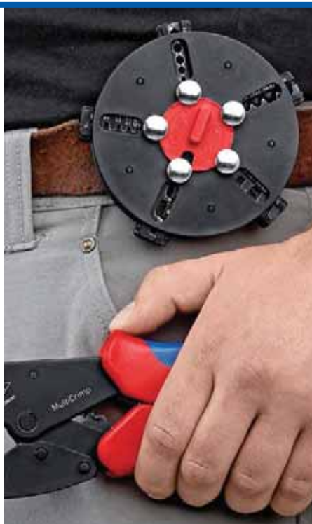
Zásobník na krimpovací nástavce lze nosit na pásku
