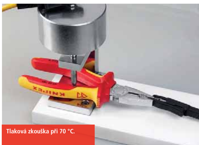
Zkouška přilnavosti izolovaných rukojetí s 500 N.
