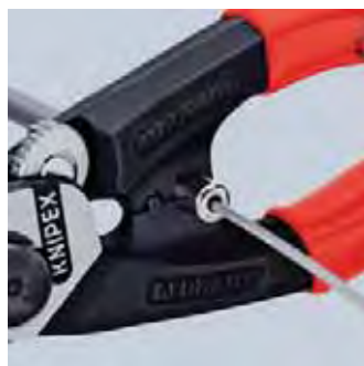
Nalisování koncovky na kryt bovdenu
