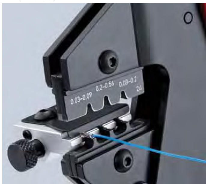
97 43 200 s lisovacím nástavcem 97 49 24 a polohovací pomůcka 97 49 93 pro konektory D-Sub
