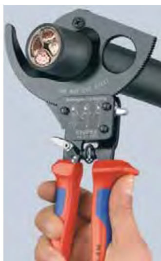
Princip rohatky se západkou a dvoustupňový pohon ozubeným věncem pro stříhání šetřící síly
