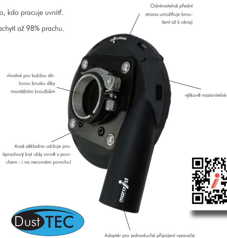
bezprašné broušení v rozích
