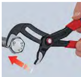
Přiložit čelist – jednoduše přesunout kleště
