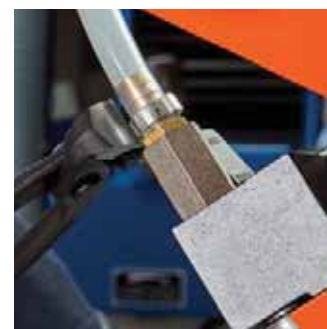
Utěsnění připojení hadice na centrálním mazání
