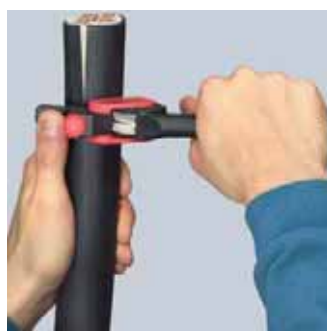
Otáčení nástroje pro obvodový řez
