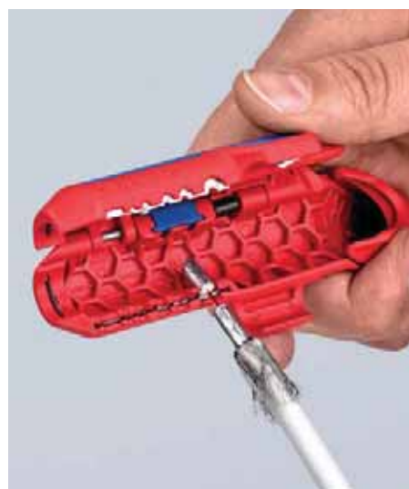
Odizolování koaxiálního kabelu
