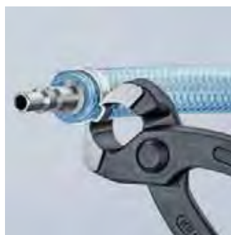
Utěsnění pneumatické hadice na rychlospojce
