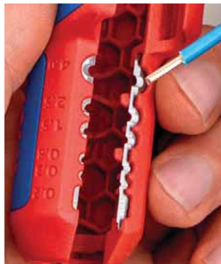
Odizolování jednotlivých vodičů
