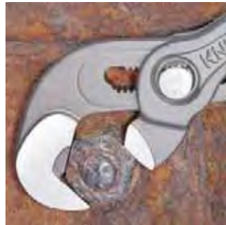
Práce se zrezivělou maticí se zaoblenými hranami
