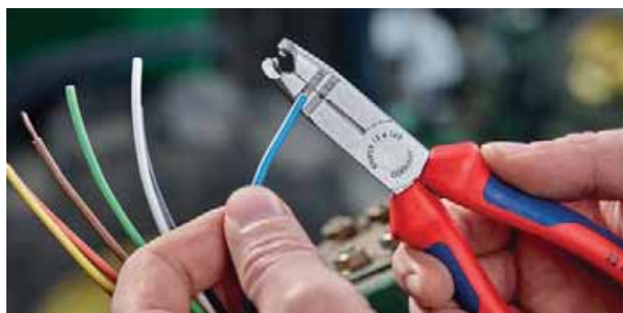
Otvory pro odizolování pro vodiče 1,5 mm 2 a 2,5 mm 2
