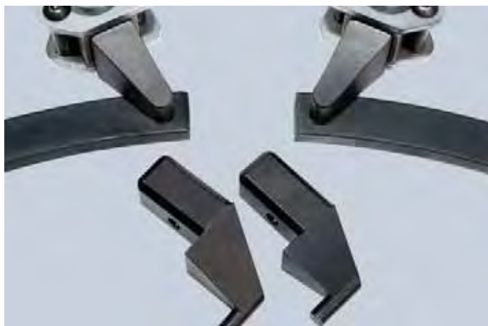
Výměnné nástavce pro vnitřní a vnější kroužky
