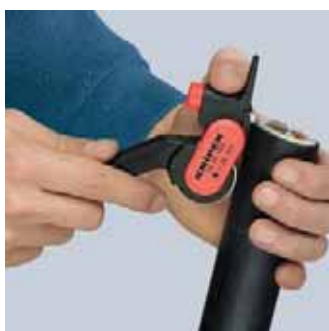
Nasazení nářadí pro odstrižení v podélném směru
