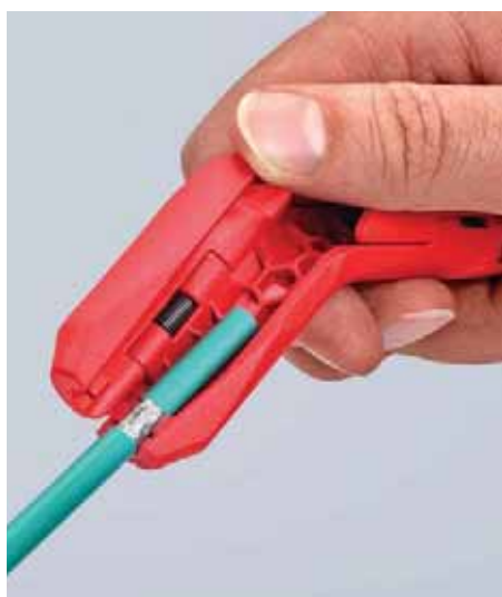
Odizolování datového kabelu
