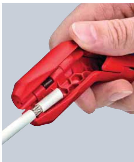
Odizolování koaxiálního kabelu
