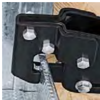
Nasazení kleští na dva spojované profilované plechy
