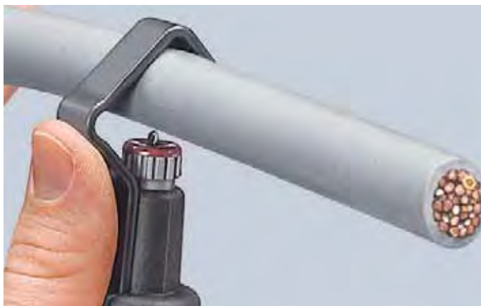
Nastavení nástroje pro obvodový řez
